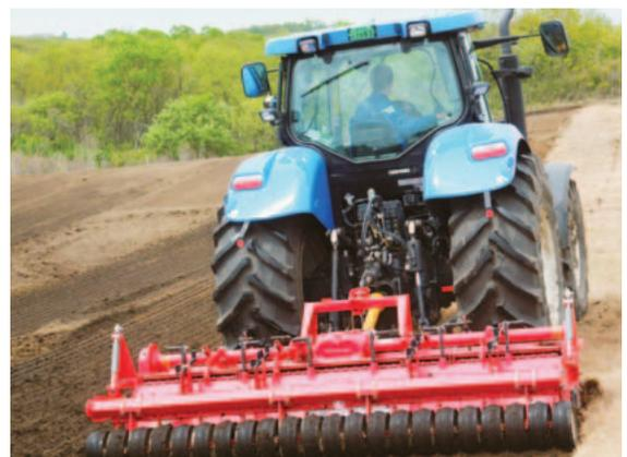
写真1 アッパーローターによる「表層攪拌更新」
