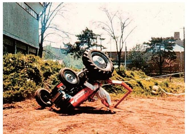
トラクタ転倒時の防護装置
