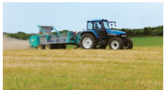
写真 専用散布機によるライムケーキの活用状況
