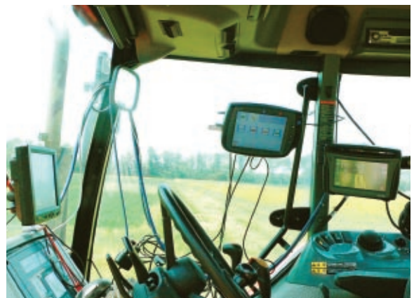
写真1 複数のGPSガイダンスシステムの比較試験
