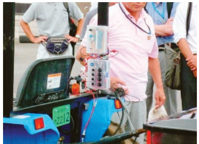
写真1 GPSを活用した速度連動施肥コントローラー 「オホーツク新農業機械実用化実践セミナー」(H23.8.30)
