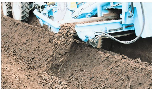
写真2 セパレータで土塊、石礫を排除
