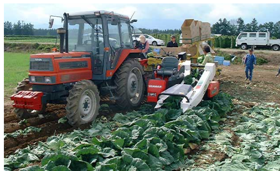
写真2 キャベツ収穫作業 収穫・箱詰め・排出同時行程体系
