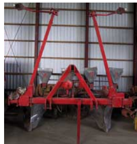
写真1 播種床造成土寄せ機械
