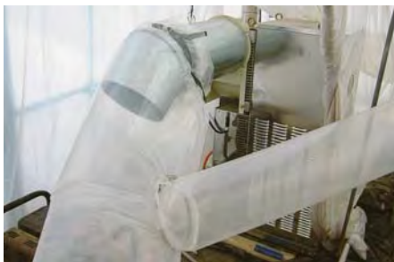
炭酸ガス発生装置(プロパンガス使用)
