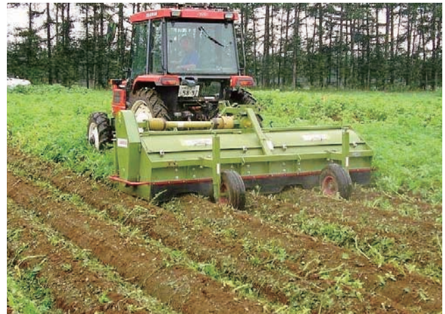
写真7 トラクタ直装式茎葉チョッパー (4LKBR300)
