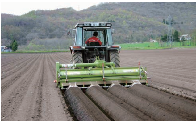
写真3 砕土装置付き培土機 (早期培土栽培)
