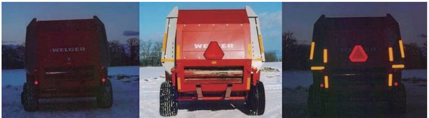
(左) 低速車マーク・反射テープの装着なし ほとんど見えない状況
