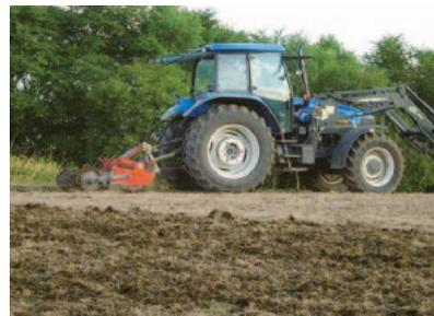
写真1 ロータリーハローによる表層攪拌
