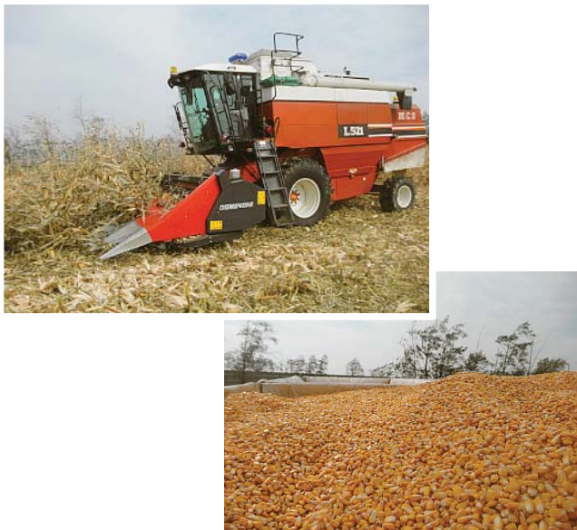
写真2 普通型コンバインと専用ヘッダーによる収穫作業と子実(品種P9027)
