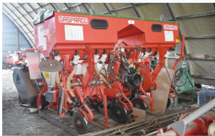
写真2 播種には、真空播種機を使用。畝幅は66cm、株間は16cm。種子は9400粒（10a当たり）で一粒播き。80%以上の発芽率を確保しています。
