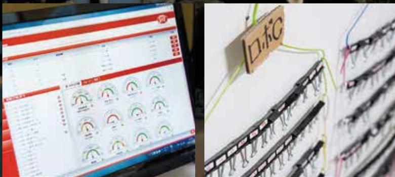
搾乳ロボットの監視モニター（写真左）。1頭ずつの乳量や乳質などをチェックできます。場長がハンガーとクリップで手作りした牛群管理システム（写真右）。何番の牛が牛舎のどこにいるのか、一目で把握できます。
