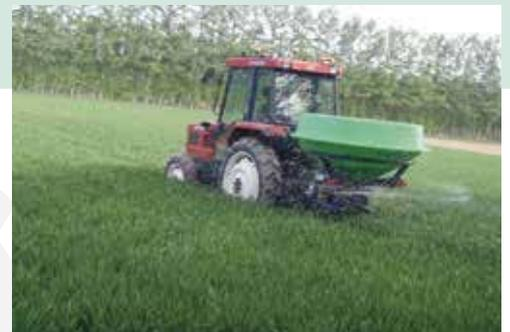
速度連動ブロードキャスタによる施肥試験の様子（十勝農試）。ブロードキャスタの施肥量自動制御では肥料ゲート開閉が制御信号に正確に応答することが必要です。肥料カスの固結、詰まりがないことを確認しましょう。
