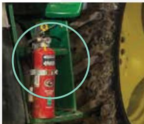
トラクターに消火器を装備。エンジンの熱を防ぐシールドも自作して取り付けました。
