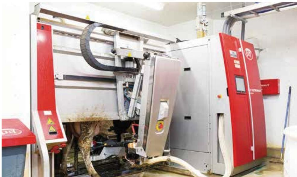
◀オランダ・レリー社の搾乳ロボット「アストロノート」を6台導入。配合飼料でロボット内に牛を呼び込み、乳頭をレーザーで検知して自動的に搾乳します。搾乳回数は1日平均2.8回にのぼり、乳量も向上しました。
