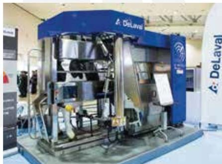
大規模酪農で導入が進む搾乳ロボット。最上位機種はサンプリング装置でミルクを測定し、疾病予防や繁殖管理をアドバイスする機能も装備しています。
