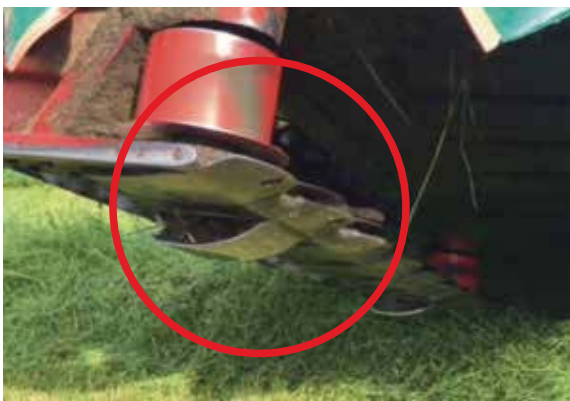
(写真2) モアコンディショナーに装着するソリ状の台
