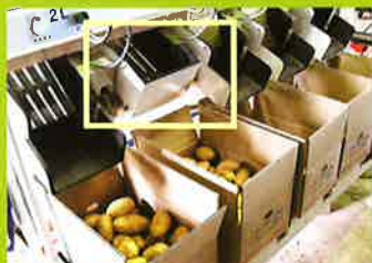
設定した重量に達すると蓋が閉じる。
