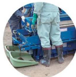
こぼれた土も両サイドのベルトで回収
