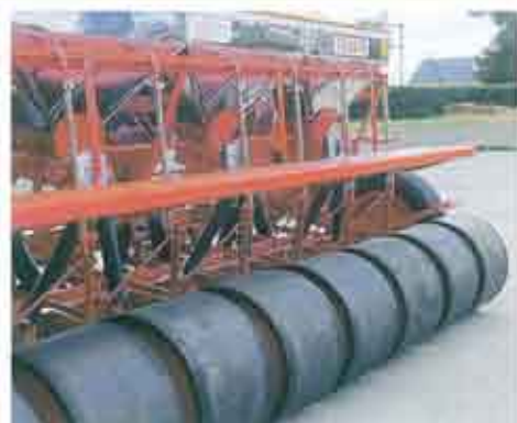
濡った時でも土が付着しにくく 鎮圧効果が生きるゴムローラー
