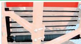
重粘土地帯でより一層の土砂分離・茎葉処理能力を発揮いたします。高速回転のローラーと、「パフォーマンスロッド・ドロッド付第2コンベヤ」とのコンビネーションで、強制的に土砂分離・茎葉処理を行います。また、ローラーにはゴムを焼き付けているので、ビートへのいたわりもバッチリです。
