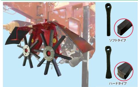
オートチェーンテンショナー内蔵で、チェーンがたるむ心配はありません。またクリーナーゴムは、ボルト4本を外すだけで簡単に8本を交換できるドーナツ型座金を用いた固定方式です。なお、クリーナーゴムには、カドにちょっとだけ丸みをつけてビートをいたわりながら処理をするソフトタイプと、先端部での威力を20%アップすることで処理能力が20%以上向上したハードタイプの2種類がございます。4本をハードタイプ、4本をソフトタイプにするなど、品種(茎葉の量)やタッピング状態、ほ場条件などに合わせてセットできます。
