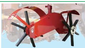
掘り取る前のビートの茎葉処理不足は、飲み込み不良の原因となります。サイドシングルクリーナーよりもクリーナーゴムが4本多い12本のため、つぎに掘り取る畦のビートの茎葉をしっかりとクリーニングすることができるので、掘り取る時に茎葉が気になりません。茎葉の量が多い品種のビートでもヘッチャラです。
