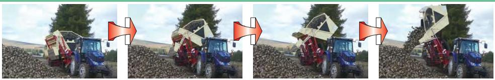
土場にビートを荷降ろしするときの落差を軽減し、ビートへのショックをやわらげつつ、高い山を形成します。しかも、ゴムを多用した本格派仕様です。そのうえ、タンクとの“運動”⇒“固定”的り替えは、レバー操作で簡単に行えます。
