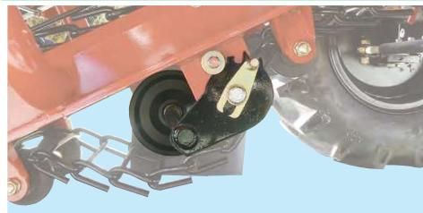
大きなローラーが、ロッドチェーンの中央部で最適なテンション効果を発揮します。テンション位置の変更方法は、支点ボルトを緩めてテンション止め金具をずらすだけです。飲み込み性能を悪くするロッドチェーンの緩みを、簡単に調整できるようになっております。
