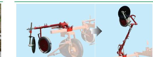
ロータリーハローに装着するNMR-1800は、どうしても全長が長くなってしまいます。しかし、サイドビームが跳ね上げ式となっているので、簡単に全長を短くできます。ですから、狭い場所での旋回、移動も簡単に実行することができます。
