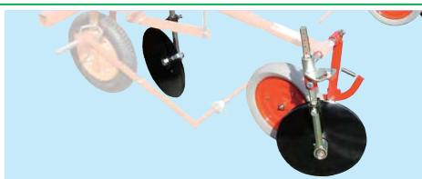
フィルムを張る前に溝を切る、フィルムを押さえつける、フィルムを押さえるための覆土、この一連の作業を1度に行います。回転部にペアリングを使用したディスクコルターは、土の切り込みが良く、耐久性もバツグンです。また、覆土用ディスクコルターの作用強さは、ハンドル操作で簡単に調整できます。
