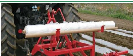
長い畦の途中でフィルムを使い切ってしまった、予備のフィルムは重たいから持ち歩くのは大変、フィルムを畦の端に置いて取りに行くのは面倒、そんな煩わしさを解消いたします。マルチフィルム台に予備のフィルムを載せておけば、無くなった所からすぐにフィルムを継ぎ足して作業を開始することができます。
