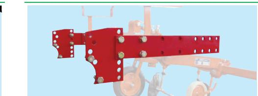
さまざまなメーカーと大きさがあるロータリーハローに取り付けられるNMR-1800には、あらかじめ多くの取付穴を設けてあります。ですから、ご使用になるロータリーハローに合わせて、最適な位置関係で取り付けることができます。しかも、ロータリーハローに対して、マルチヤー本体をオフセットして取り付けることもできます。
