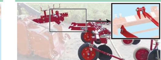
ロータリーゲンだけを行いたいとき、装着したNMR-1800は邪魔になるうえ、機体を重くしてしまいます。しかし、ロータリーハロー取付部とマルチヤー本体部が着脱式となっているので、簡単にマルチヤー本体部を外すことができます。
