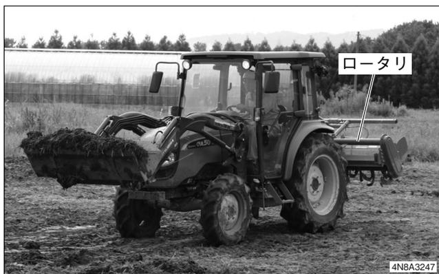
作業機はいっぱい上げて作業機降下速度調節グリップを《固定》にして作業機が下がらないようにします。
