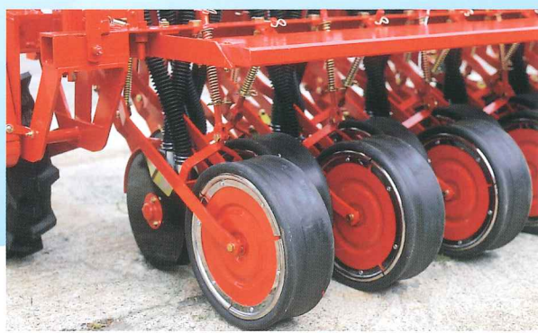
▲湿った時でも土が付着しにくく鎮圧効果が生きるゴムローラー（オプション）
