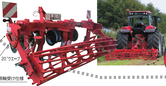
コールタが先行し、麦稈や豆殻を切断し、引きずり防止
