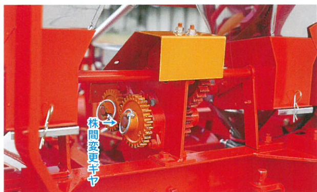
▲ 播種株間は、本機中央ミッションギヤにより全ての播種部株間の調節が一ヶ所でできます。
