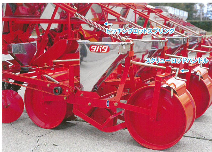
▲ 播種深さは、スクリーロードにより前後鎮圧ローラーが同時に上下し、地面に対し常に種子箱が平行に上下します。スクリーロードハンドルで深さの微調節まで簡単にできます。
