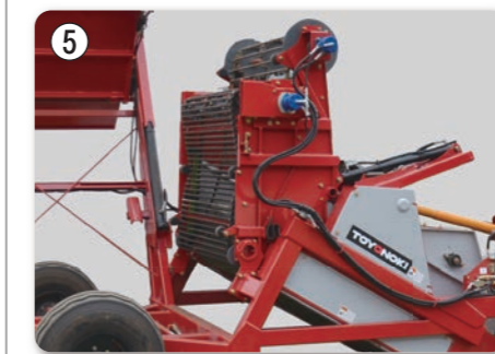
スターローラー後部にある折畳コンベヤは石タンクの中心まで伸びており、石礫を無駄なく積み込むことができます。折畳コンベヤが折畳まれた状態でない石タンクのダンプアップができない構造のため、誤操作防止も万全です。
