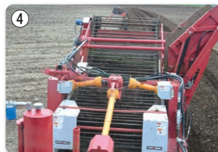
スターローラー上部にあるバリフローコンベヤは石礫と土砂・土塊との分離速度を調整する働きと、石礫をスムーズに石タンクに排出する働きをします。土塊が砕けにくい場合、コンベヤ速度を遅くして土塊をスターローラー上に滞留させ、砕土性を向上させます。また、石礫が多い圃場ではスターローラー上に長く滞留させると圃場に石が落ちやすくなるため、コンベヤ速度を速めることでスムーズに石礫を石タンクに排出することができます。コンベヤの速度調整は機体のスロットルチェックバルブで行い、圃場条件に合わせて効率良く作業することができます。
