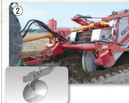
2枚の30インチ遊転ディスクは掘取り深さを決めて土寄せする機能があり、1,840mmのワイドな作業幅と最大300mmの作業深を誇ります。また、荷重を受ける軸受けには大型のテーバーベアリングを採用し、大量の土砂をスムーズに土砂分離行程に移行させることができます。
