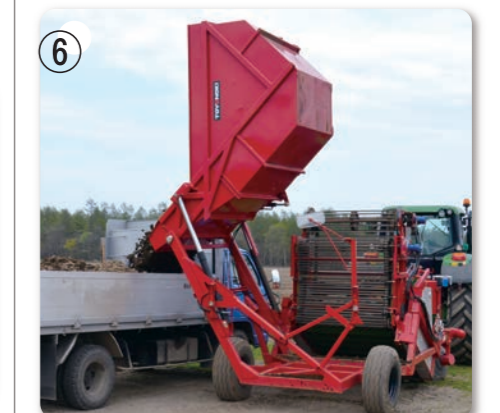
1.4m 3 の石タンクは、約2.5トンの石礫を収容することができます。タンクの支点高さは2,130mmで、3トンドンプに直接排出可能です。
