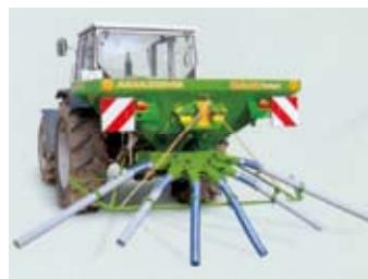
ロークロップアタッチメント2、4、6条及び90cm間隔まで施肥間隔を自由に設定できます。一般にコーンの葉の下に肥料を散布する時に便利です。
