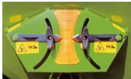
散布量のセットはブロードキャスターの後方に独立して取り付けられた2本のレバーによって調整できます。
