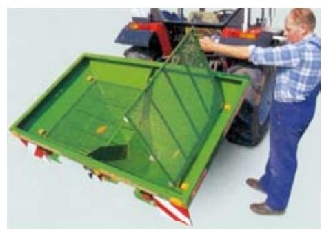
スクリーニング グリル(網)は作業中肥料に紛れ込んだ石、異物を除き駆動部を保護し、散布精度を維持します。(標準)
