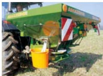
散布量確認装置（キャリブレーションデバイス）は散布量を確認するために使用します。決められた距離を移動することによって集められる肥料の重量が測定されます。その数値からスケールによって精度の高い散布量を求ることができます。
