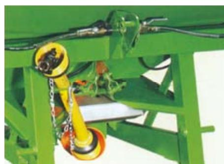
左右独立式の油圧シャッターにより変形の圃場や片側散布の場合運転席から開閉のコントローラができ大変便利です。
