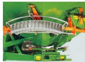
リミッターXは最新の境界線散布システムです。最初のトリムラインの作業時及び圃場際の散布に使用します。面倒な調整はいりません。境界線散布と通常散布の切り替えはトラクタに乗ったまま油圧で操作できます。
