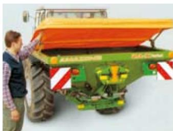
雨天の場合折りたたみ式のホッパークリーバーをセットすることにより、肥料を漏らすことがありません。ブレーキ、ワインカーの灯火装置も装着でき、更に安全性が高まります。
