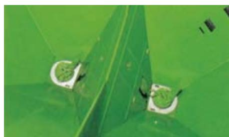
2分割のホッパーは左右の散布デスクに肥料を均一に送り込みます。もし散布量が左右異なる場合残った肥料の量から容易に判断できます。
