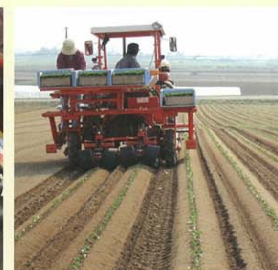
STP-2MSTによる移植作業
