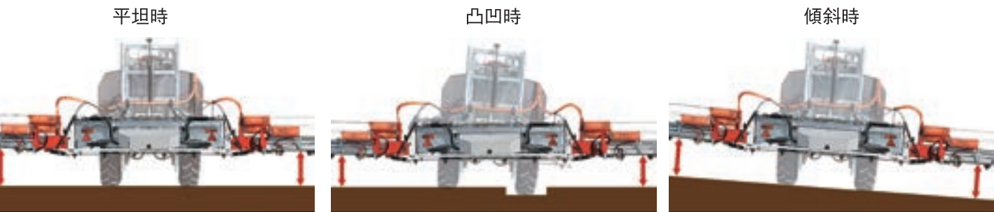
圃場の凹凸があってもブームの水平が維持されます。 傾斜地でもブームの傾きを調整することで、左右の散布高さを一定に保てます。
