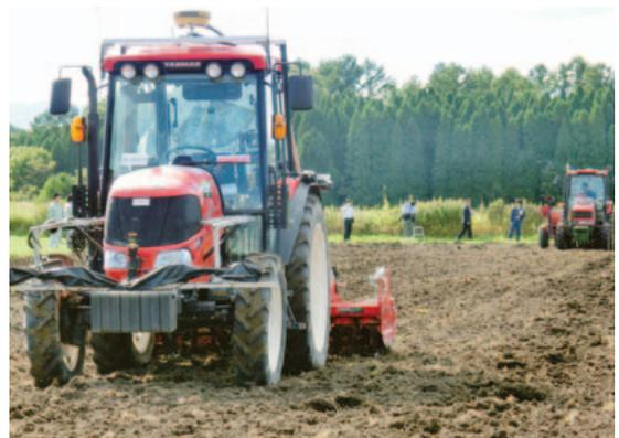
写真1 無人ロボットトラクターと有人トラクターの縦走式作業
