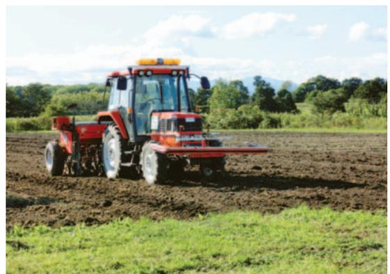
写真2 ロボットトラクターによる小麦播種作業
