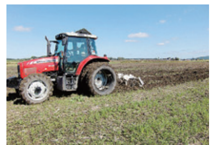
写真1 サブソイラの施工
