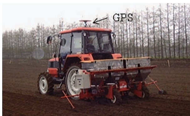
写真1 4畦用可変施肥機によるマップ施肥
