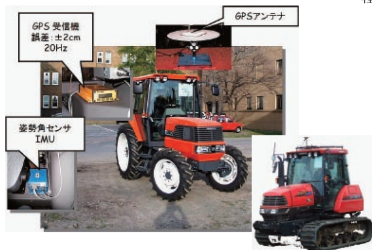
図1 ロボットトラクタと航法センサ
