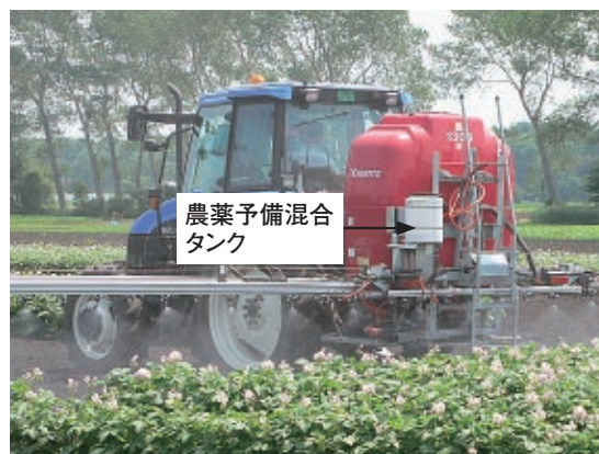
図1 農薬自動混合装置付速度連動型防除機
