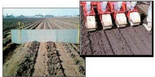
鼓型鎮圧輪(上)と慣行鎮圧輪(平滑円筒型)(下)
