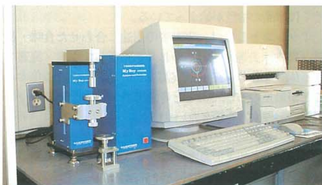
写真 炊飯米物性の測定機器（テンシプレッサー）
