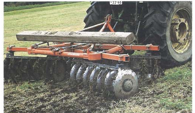
ディスクハローによる表層攪拌
