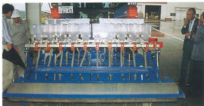
写真1 乾田播種早期湛水栽培用移動スクリーンロータリーシーダー
