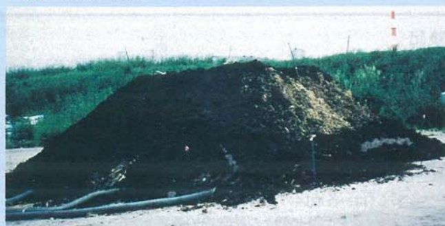
堆積の状況（この規模で約45t程度）
