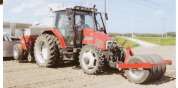
写真4 フロントへの鎮圧ローラ取り付けとダブルタイヤ装着
