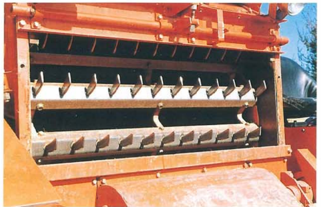
写真2 脱穀部・シリンダーの清掃点検
