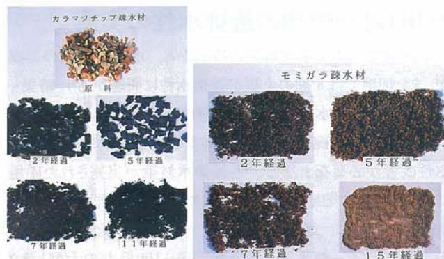
写真-5 籾殻とカラマツチップ材の分解の比較
