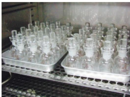
「ウインクラール・アジ化ナトリウム変法」の測定過程
