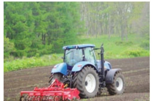
写真1 アッパーローターによる表層攪拌作業
