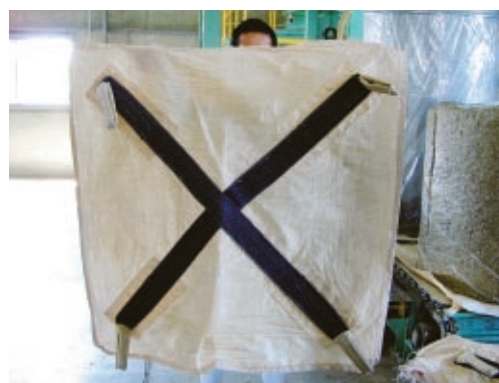
【写真2】 運搬用の下敷き材（モッコシート）
