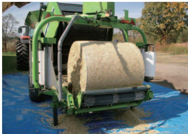
写真1 細断型ロールベアラー(株)IHIスター製
