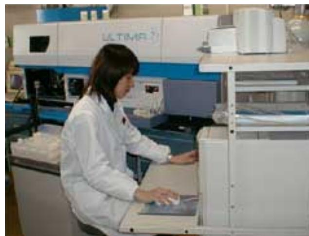
写真2 ICP発光分析装置(米のカドミウム分析に使用)
