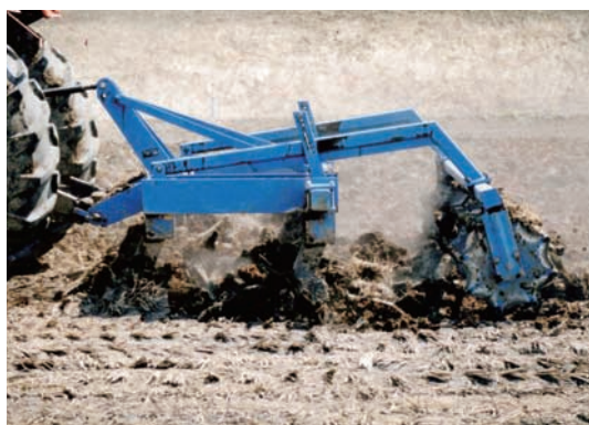
圃場の乾燥化を促すソイルクランブラ(チゼル耕起)
