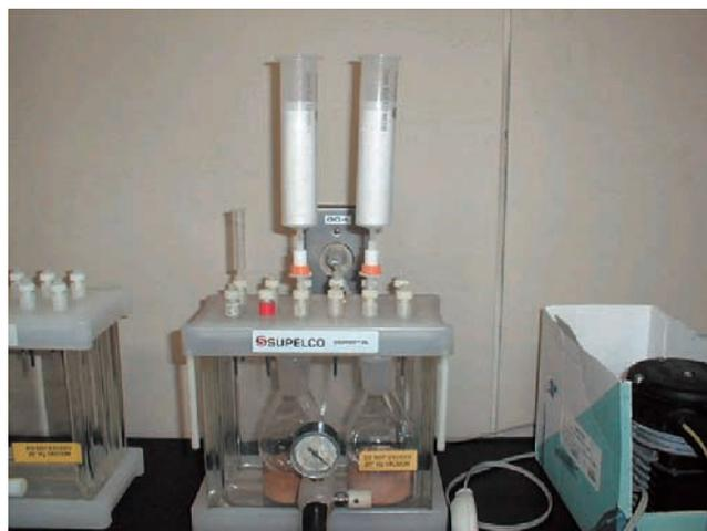
写真 作物抽出液の脱水、精製工程
