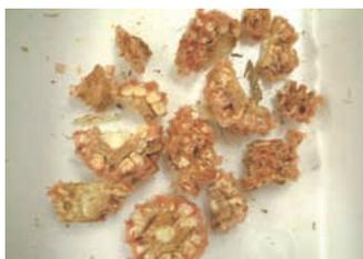
写真2 切断長19mmローラ間隔5mmとうもろこし芯
