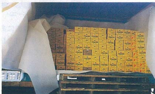
写真2 汎用コンテナ（ライトロン2mm二重包装）
