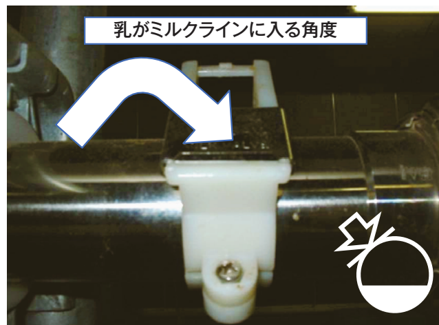
写真12 ミルクインレットの角度が11時の例
