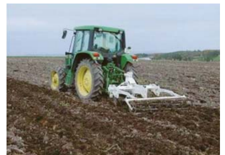
心土破碎の施工
