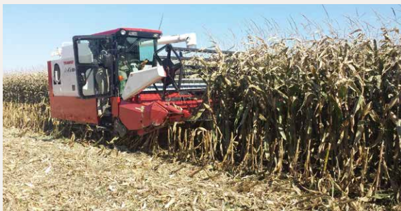
【写真2】 種まきは大豆用の播種機、農薬散布はスプレーヤー、施肥 はブロードキャスター、収穫は国産汎用コンバインの兼用が可能。海 外製のコンバインなら雌穂を取りこぼさないよう専用のスナッパーヘッ ドを装着することもできます。
