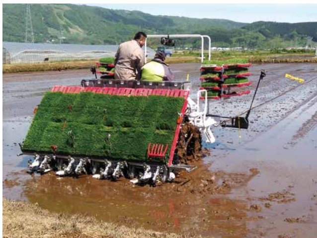
写真 4. 密苗の移植作業。田植え機に一度に3倍の面積分の苗を積めるため、苗の補給を行う回数が少なくて済む。
