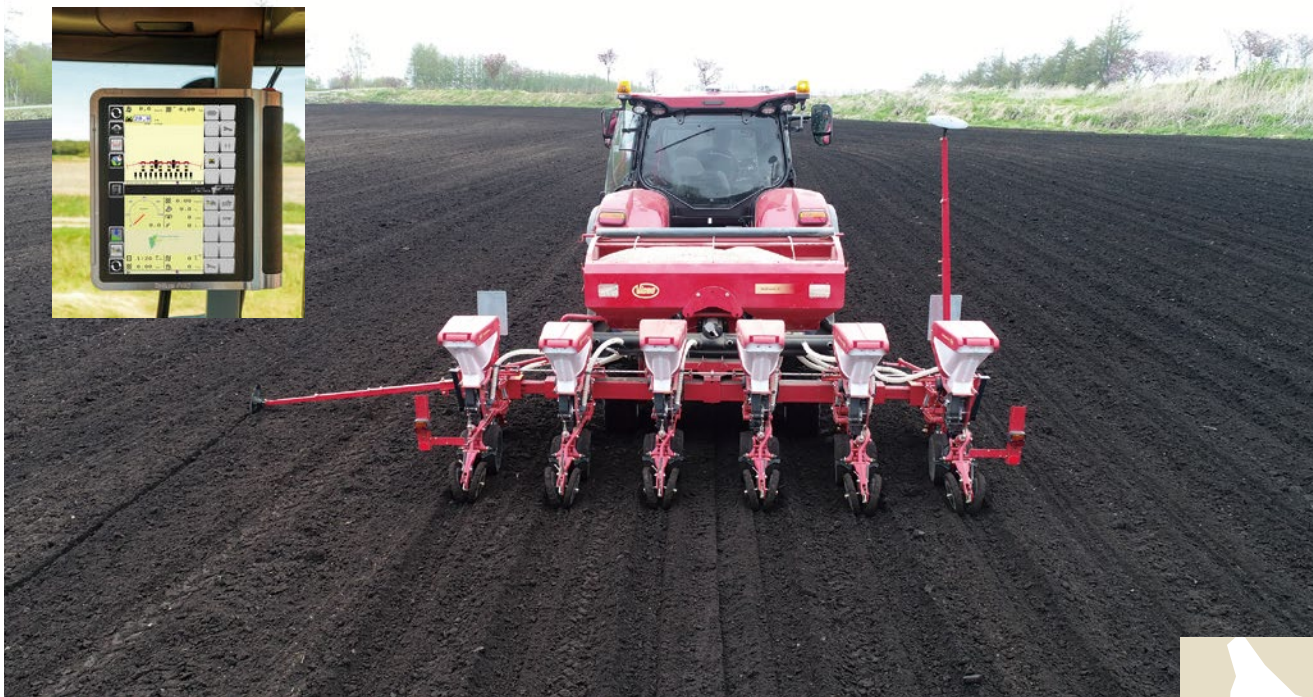
写真1. 真空播種機（ピコンジャパン Multicorn DP II・6 畦タイプ）による播種作業の様子と ISOBUS コントローラー（ISO Match Tellus）（左上）
