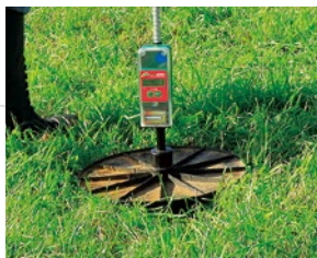
写真2.ライジングプレートメーター（左～シャフトにつけた円盤が草で持ち上がる高さを測る）で、毎日草地を測定。放牧に使った牧区1区画につき50カ所、2歩に1回ほど地面にメーターを下ろします。1日30分ほどかけて測定し、目視でも情報収集。スマホアプリと連動する機種もあります（中、右）。
