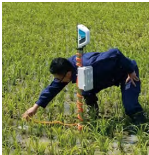
写真2. センサーの圃場への埋め込み
