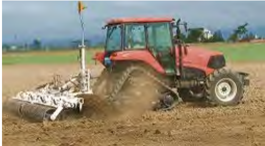
レーザー均平機での施工
